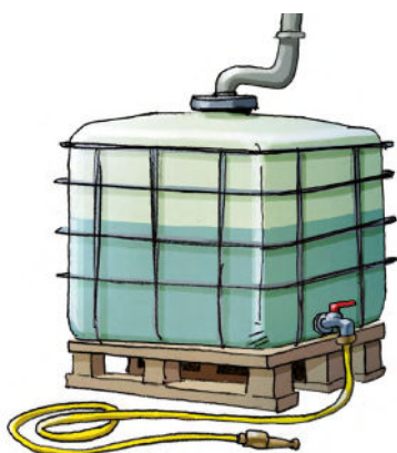
Cuve de récupération d'eau de pluie
